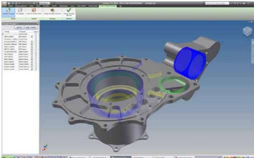
Le Gestionnaire de modifications, intégré à la technologie Inventor Fusion, signale les modifications des fonctions à l'aide de couleurs différentes. La position initiale est en bleu, la nouvelle position en jaune, et les fonctions nouvellement ajoutées en vert. (Source : Autodesk)
