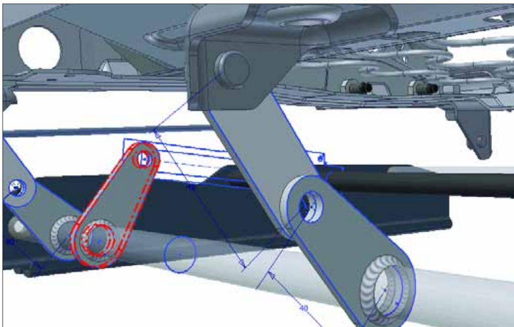
En cas de modification des paramètres dimensionnels dans les esquisses sous-jacentes, le modèle géométrique 3D s'adapte immédiatement. (Source : Autodesk)
