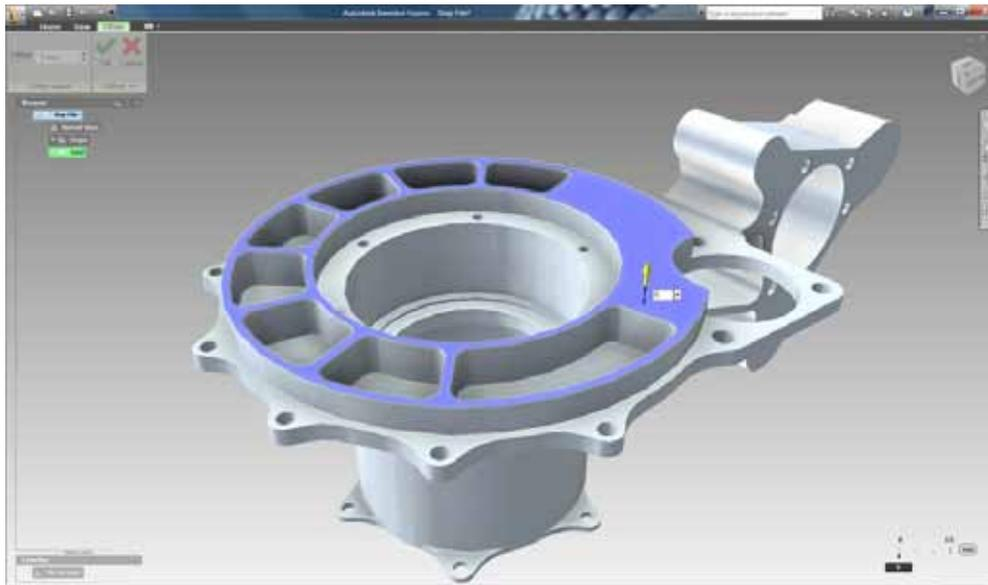
L'approche de la modélisation directe de la technologie Inventor Fusion permet aux utilisateurs de sélectionner, puis de réduire ou d'agrandir des surfaces, tout en bénéficiant d'un retour d'information visuel en temps réel.
